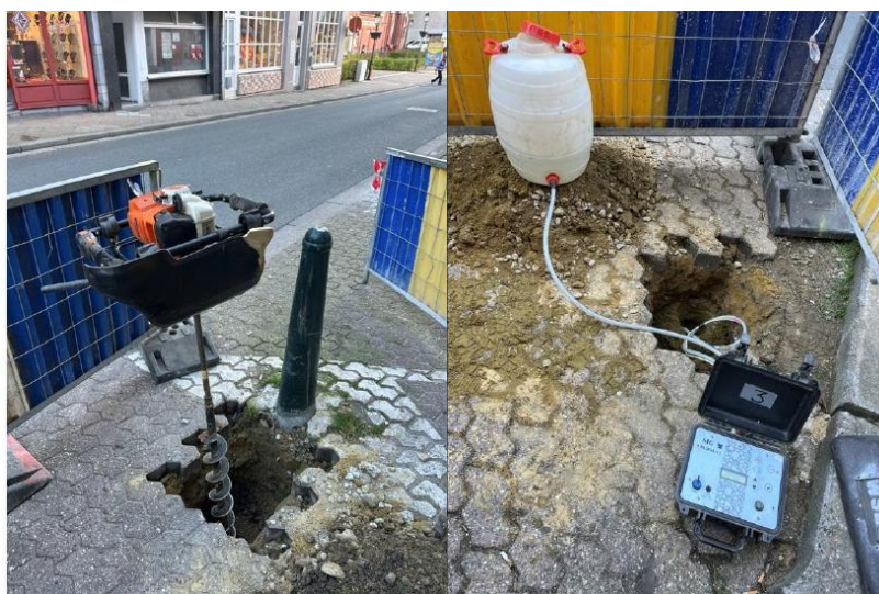
Figure 81 : Réalisation des tests d'infiltration (source : Solor)
